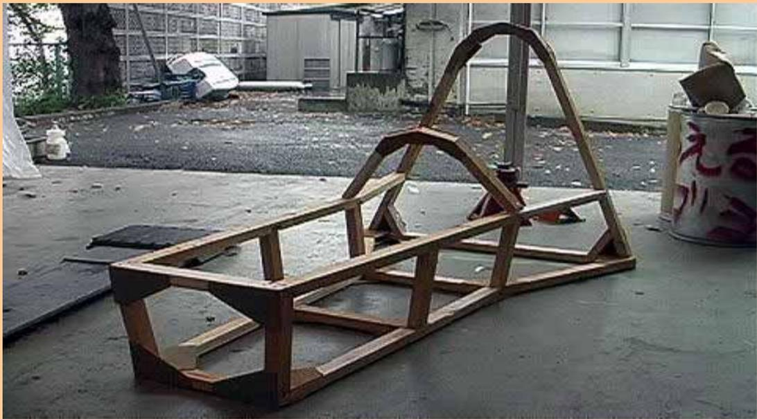
特に難しかった事と言えば、フロントフープやメインフープのカーブを再現することでした。実際には多角形にしましたが。更にフロントフープのカーブしている部分に、左右で非並行のアップパーフレームが繋がる為、木材を切断する角度等を求めたり、その通りに切断し、接合したりするのが面倒になるはずでした、が、実際はそこまでやる気力も時間も残っていなく断念しました。作り始めてから、木材の断面が平行四辺形の様に変形していたり、全体的に縮んでいたりに気づき、手遅れになってしまった事もあり、意外に大変な作業でした。
